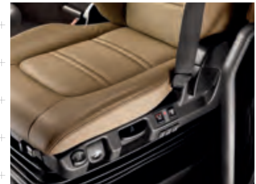
ÚJ, FŰTÉSSEL ÉS SZELLŐZÉSSEL ELLÁTOTT VEZETŐÜLÉS
